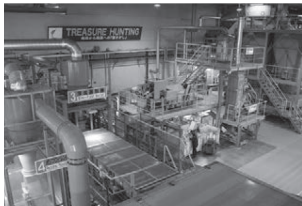
洗濯機のPPを低コストで回収する浮沈選別システム
