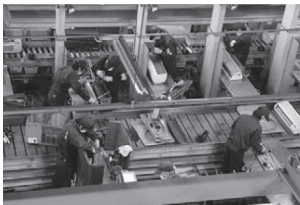
エアコンはフロン回収後、室内外機を分解
