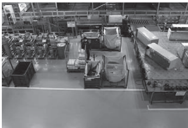
冷蔵庫は断熱材発泡剤（フロン、シクロペンタン）ごとに破碎
