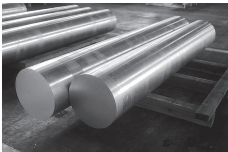
導入設備で製造したマグネシウム合金ビレット（φ 300mm）
