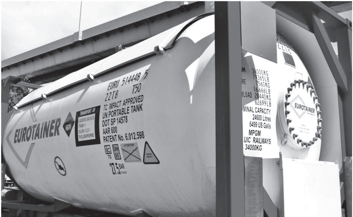
1233zd (E) の移送に用いるISOタンクコンテナ（セントラル硝子株式会社提供）
