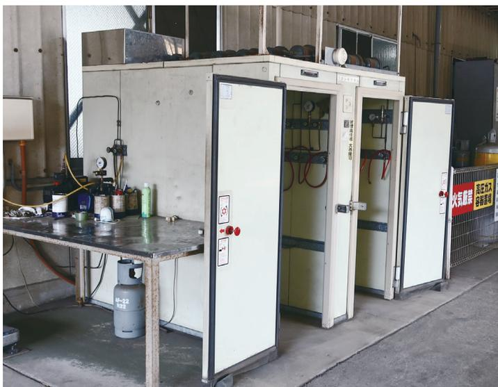
三宅産業に設置されている簡易蒸留型フロン再生装置
