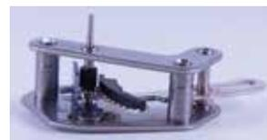
圧力計の内機に用いる歯車機構を従来の機械式から磁気式に置き換えた。磁気歯車は非接触のため、摩耗がなく注油の必要がない。しかもコンプレッサーなどで生じる細かい振動は磁石間で吸収され指示針に伝わらないことから、長寿命で安定した表示を実現できる。
