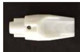
ライトニックスは植物由来の樹脂製(100%ポリ乳酸)からなる「完全単回使用の経皮用ワクチン接種針」を開発した。接種針の先端にマイクロサイズの溝と貫通穴を持つ3次元立体薬物貯留チャンバーを超微細成形加工し、経皮内に微量のワクチンを投与する構造となっている。従来の金属針や剣山型マイクロニードルではできなかった穿刺の深さの位置を確実にマイクロメートル(1000分の1mm)単位でコントロールできる。
