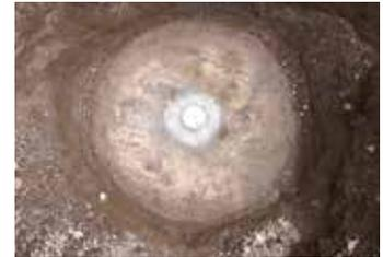
efコラム工法は地盤の支持力を高める独自の地盤補強工法で、報国エンジニアリング（大阪府豊中市）、設計室ソイル（東京都中央区）、樋口技工（東京都江戸川区）の3社が共同開発した。従来工法は、建物の重みで沈み込まないよう改良体と呼ばれる構造物を地中に埋設し、建物基礎と地盤の間を支えている。支持力を高めるには改良体の大型化が必要だが、材料使用量が増えてコスト増につながっていた。
