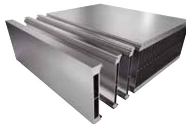
ヒートシンクとはアルミなどの高い熱伝導性を持つ金属を加工して製造される放熱・排熱部品の総称。丸三電機が開発した「幅広カシメ式ヒートシンク」は、押出成形した幅9mmのブロック状ヒートシンクを何層にも積層して圧力をかけ、解放した瞬間に部材の弾性により元に戻ろうと反発するスプリングバックを応用したカシメ方法で、幅約795mmまでの製造が可能だ。
