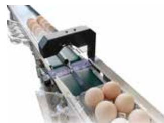
ナベルが開発した「パック卵検査装置」は、透明パック容器に詰められた卵に赤外線を照射し、画像解析によって卵の割れや中身抜けを検出する。指向性が高い発光ダイオード(LED)の採用や照射角度の調整などにより、従来困難だった卵下部の割れも高精度で検出可能となった。
