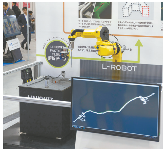
ティーチング自動生成ツールを利用したロボットコントロールシステム「L-ROBOT」 Robot control system L-ROBOT uses an automated teaching tool.
