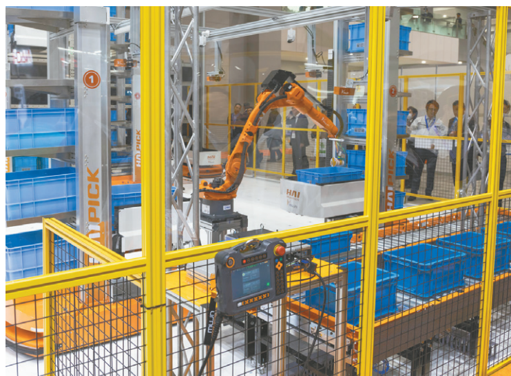
ピースピッキングロボットと自動倉庫ロボットの組み合わせで物流を自動化する Automating logistics through a combination of piece-picking robots and automated warehouse robots.
