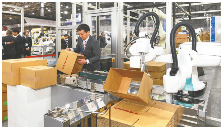
サイズ違いの段ボール組み立てを自動化でき、段取り替えが不要(川崎重工業) Kawasaki Heavy Industries robots can automatically assemble cardboard boxes of different sizes with no set-up necessary.
