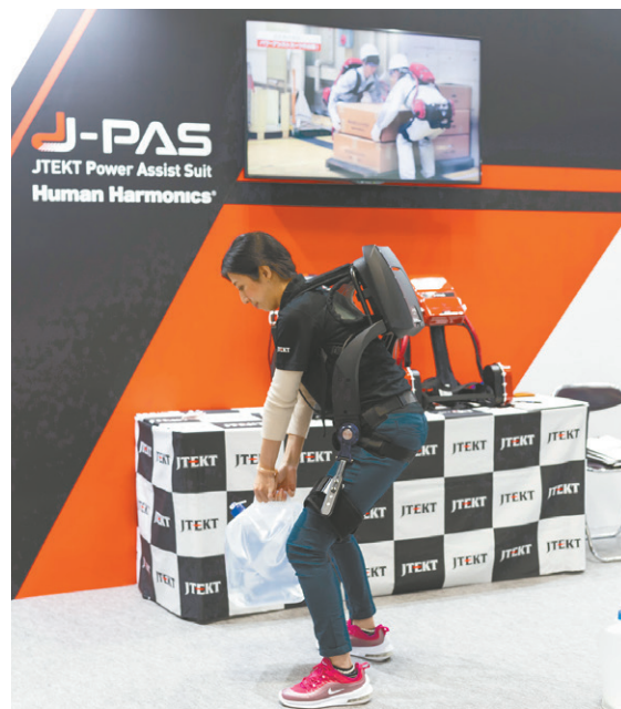
人の動きに調和して重量物搬送を手助けするパワーアシストスーツ(ジェイテクト) JTEKT Power Assist Suits help people lift and carry heavy objects.
