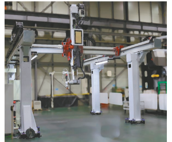
ニデックマシンツールの「LAMDA2000」 独自に開発したローカルシールド機能とプロセスモニタリング AI フィードバック機能を持つ P-DED 積層ヘッドに回転 2 軸を持つ機構の大型 DED 装置。大型金型の補修造形に最適 NIDEC MACHINE TOOL “LAMDA2000” A large DED system featuring a P-DED laminated head with a proprietary developed local shielding function and process-monitoring AI feedback, equipped with two rotating shafts. Perfect for large mold repairs.
