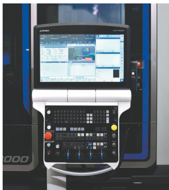
オークマの独自コンピューター数値制御 (CNC) 装置「OSP-P500」 Okuma's proprietary computer numerical control (CNC) system "OSP-P500"
