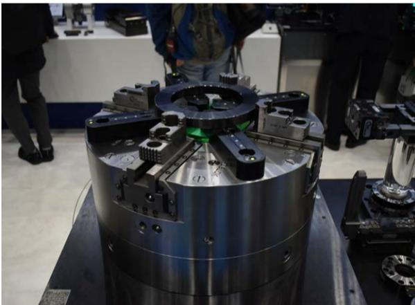
マイクロレベルで位置調整できる4モーター内蔵の電動チャック
