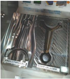
ヘキサゴンはAMマシニングによる金型補正で手作業を省く Hexagon eliminates manual work by using AM machining to correct die.
