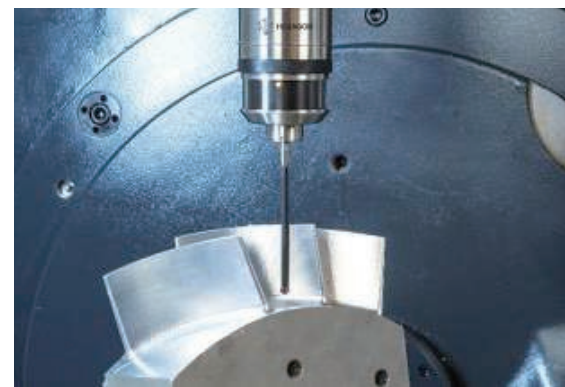
加工対象物（ワーク）の機上計測は、工程集約や高精度化につながる（キャプテンインダストリーズ提供）
