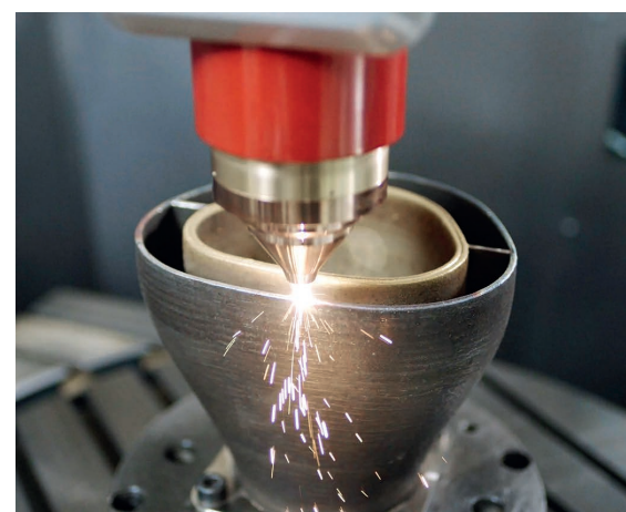
工作機械は切削加工に積層造形の機能を搭載するなど複合化が進む（DMG森精機提供）
