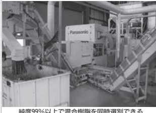
純度99%以上で混合樹脂を同時選別できる
