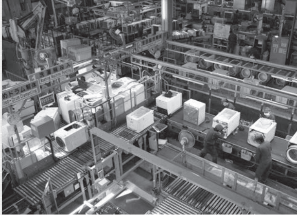
コンベヤーを流れる洗濯機の部品を手取り外す
