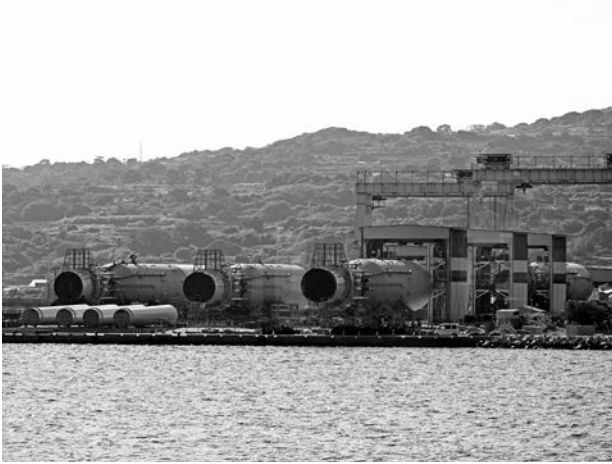
スーパー型浮体部を建造するヤード（福江港大津岸壁）
