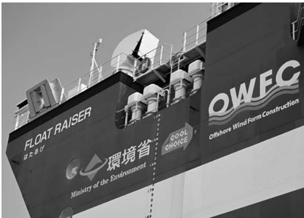
風車を設置沖合まで運ぶ半潜水型専用台船「FLOAT RAISER」
