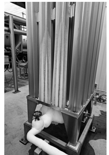
冷却で配管が凍らないように水分とCO 2 を除去するTSA吸収塔。 (右) はバイオメタン用の気化装置
