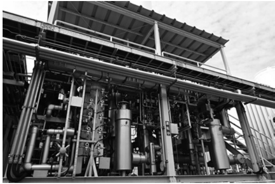
バイオガス精製設備で抽出されたメタンガスは触媒環境下で水蒸気と反応させて水素を発生させる。(右は水素貯蔵設備、左は水素製造装置)
