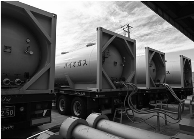
LBM製造プラントではバイオメタンをマイナス160°Cの極低温まで冷却して液化する。環境に優しいカーボンニュートラルなLNG代替燃料として利用可能だ
