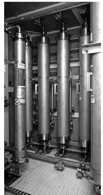
(上) メタンとCO 2 の分離膜ユニット。高分子膜に対するメタンとCO 2 の透過速度差を利用して分離する
