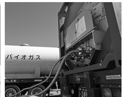
バイオメタンの低圧輸送を実現した吸着剤を使った吸蔵容器（右）とCO 2 分離膜フィルター
