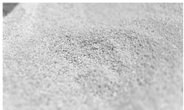
本来透明なポリエステル樹脂は固相重合によって強度を高めたことで白く見える
