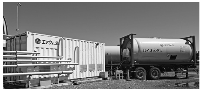
牧場でバイオガスを捕集する段階でバイオメタン（気体）化する粗精製まで行う
