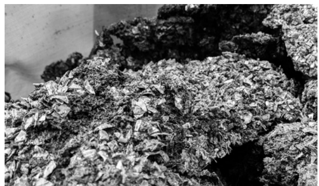
解重合工程ではPETフレークをエチレングリコールで溶かし、BHET分子に分解する。写真は解重合後に取り除かれたアルミや土砂、ラベルなどの不純物
