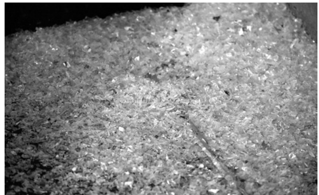
フレーク状になった廃PETボトル。CRなら不純物の混入も問題ない
