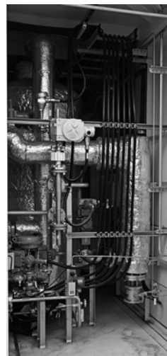
冷却で配管が凍らないように水分とCO 2 を除去するTSA吸収塔。 (右) はバイオメタン用の気化装置
