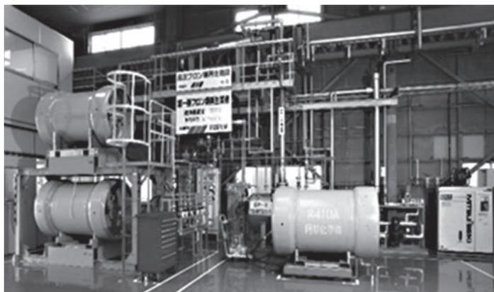
高純度再生品を製造する高圧冷媒蒸留設備
