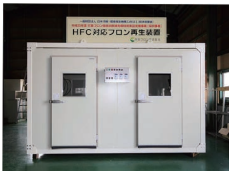
フロン再生処理センター内の再生装置
