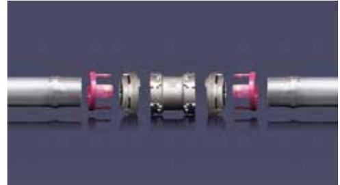
ステンレス鋼管用の新しい拡管式継手「KKベスト」は、レンチが要らず、究極の簡易な施工を実現したことで、従来製品と比べ接合時間を約72%短縮できる。また生産性の向上に加えて、施工品質を均一化できる構造や機能設計を採用しているため、技能レベルに左右されず、トラブルを未然に防止できる。
