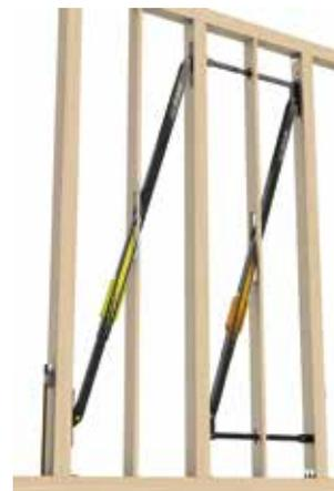
木造住宅の壁に配置するダンパーとして機能し、地震の揺れを吸収する。防災科学技術研究所での2階建て住宅の振動台実験の結果、通常の筋交い補強に比べて最大揺れ幅を80%低減できることを確認した。金属流動は摩擦の一種。通常、鋼材同士を摩擦すると表面が摩耗して部材厚が減るのに対し、特殊なアルミニウムは摩擦係数が高いため、鋼材との接触面で焼き付き完全密着しながら変形する。これを金属流動と呼び、特許を取得した。
