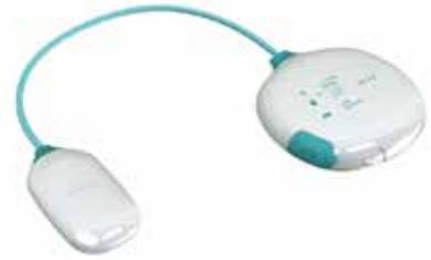
排泄予測デバイス「DFree」は、排尿のタイミングを事前予測できるウェアラブル端末。エコーの技術を応用した人体に影響のない超音波センサーを利用者の膀胱の前に装着。膀胱の大きさや伸縮のスピードから、排尿のタイミングを独自のアルゴリズムを活用し、データ収集する。取得したデータはBluetoothやWi-Fiを介してクラウドに送り、分析結果を排尿後に介助者のスマートフォンやタブレットへ通知する。アプリ上ではデータをグラフ化し、排尿のタイミングを視覚的に認知できる。高齢者や尿漏れ・脊椎損傷に悩む人が利用することで失禁の不安を和らげ、自立排泄を支援する。
