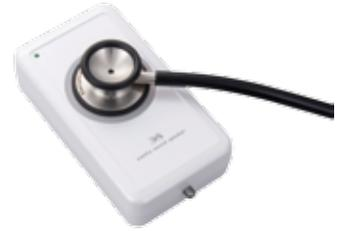
聴診トレーニング専用スピーカー「聴くゾウ」は、医療系大学などで聴診の訓練に使う。生体音をリアルに再現でき、心音や肺音など20-50Hzの低音も再生できる。聴診器をスピーカーユニットが接触するシリコン面に当てて再生された音を聴く。パイオニアが技術協力し、同社製の重低音スピーカーを採用した。手のひらサイズで携帯性に優れる。外部からのノイズを遮断するため筐体下部に防音ゴムを設置。さらにスピーカーユニットを筐体内上部にシリコンを挟んで固定。この構造により生体内に似た環境を再現している。
