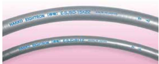
「導電スーパー柔軟フッ素ホースシリーズ」は、ホースの流動帯電による静電気放電に起因した可燃性物質の着火や爆発などを防止する静電気対策を講じている。これまで内層がフッ素樹脂の製品は、導電性外部カバーのホースや導電ライン入りのホースのみで、一般的にホースは厚い絶縁性樹脂の内装体で構成されていた。さらに導電ラインはスプレーガンなど端末機器の静電気を除電するアース機能で導電ライン以外は絶縁体のため、ホースの流動帯電は防げず、使用者の誤解を招く危険が生じていた。
