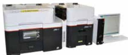
有機微量元素分析装置JM11型は、国産では唯一、炭素水素分析法であるPregl法と窒素分析ではDumas法を組み合わせ、水素、炭素、窒素の3元素を同時に分析する。測定対象は固体や液体など各種形態の試料に対応しているため幅広い分野で活用できる。
