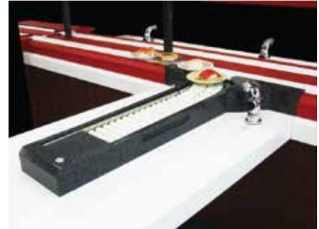
回転寿司専用コンベヤーのトップメーカー、石野製作所は外食業界用注文品搬送装置「Auto Waiter (オートウェイター)」のコンベアを直進だけでなく90度曲げられるよう改良した。都市型店舗は物件の広さに制約があるため、90度曲がるタイプの方が店舗内のレイアウトがしやすい。回転寿司店であれば店員が移動して寿司を置く手間が省けたり、注文した客が寿司をとったかどうか死角がなくなったりするなどで作業性も向上する。
