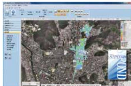
「SIPOND (エスアイ・ポンド)」は、ため池(貯水池やダムを含む)を主対象とした二次元不定流による初の本格的な実用氾濫解析ソフトウェア。基盤地図情報などオープンデータを取込み、豪雨や地震などでため池が決壊した時に備え、浸水リスクや河川の氾濫リスクを分析し、下流域の浸水被害想定や浸水ハザードマップの作成に活用できる。さらに降雨、土地利用、排水路などの豊富な解析パラメーターにより、対策計画時の効果算定も可能。
