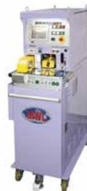
本装置は厚さ40 $\mu$ mの電子部品のフープ材を溶接によって継ぎ足すことができ、部品生産の連続作業を可能にした。従来、この薄さのフープ材は溶接による継ぎ足しができなかつたため、材料が切れた場合は新たな材料をプレス機に通し直す必要があり、作業時間と材料のロスが発生していた。さらに加工が複雑になるに従ってプレス工程も増え、作業によって品質のバラツキが生じ、不良品の発生原因ともなっていた。
