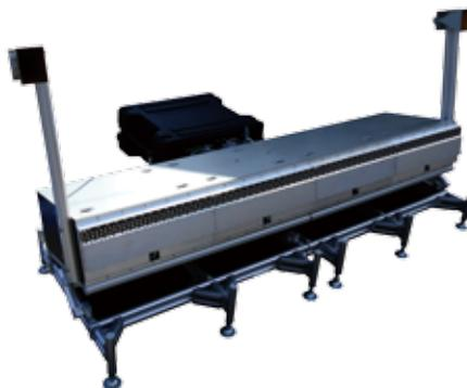
振動可視化レーダー「VirA(ビラ)」は、離れた場所から橋梁やビルなど大型構造物の表面の微細な振動まで高精度かつリアルタイムで計測し、計測後はデータを処理して解析する。本体を地上に設置して計測できるため、大がかりな足場の設置や計測器の取り付けが要らないのも利点。これまで耐震強度推定のための振動計測は建造物の中に入らないとわからなかったが、外部から計測し建造物の状態がわかるようになった。建築・土木分野だけでなく、城など文化財の耐震強度計測など、さまざまな分野への応用が期待できる。
