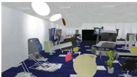
「UC-win/Road地震シミュレータ」は、3次元バーチャルリアリティソフトウェアUC-win/Road上で、地震により発生する家具や照明の揺れ、倒壊など室内の被害状況や影響を、簡易な入力により3DVRで可視化できる。従来の耐震ソフトは建物自体の構造強度や性能に特化したものがほとんどだが、本シミュレーターは業界で初めて室内の動きに着目した。
