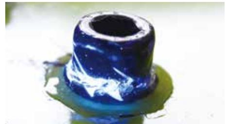
インフラ点検の重要性が再認識される中、ボルトやナットの緩みは、締め直したり、付けておいた印のずれを目視確認したりする方法で点検が行われてきた。だが一つひとつ見ながら作業をするため時間がかかるうえ、高所作業を伴う点検は危険もつきまとう。プランスケミカルは、紫外線で発光する独自開発の塗料を使った点検技術を開発。発光の有無で緩みを確認するため、熟練度を要さず、高所など離れた箇所でも容易に点検できる。
