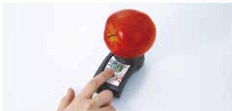
ポータブル非破壊糖度計「PAL-光センサー」は、電池駆動の携帯モデルで、機器を果実に接触させるだけで糖度を計測できる。果実生産者や果物店が、木になっている状態や店頭で測定を手軽に行え、コストパフォーマンスも良い。現在出回っている非破壊糖度計は、近赤外吸収スペクトルを得るための分光器などを兼ね備え、大型で持ち運びが不便でコストも高額なものが多い。また従来のカット方式による糖度測定では果実を分解・攪拌し液体状にして計測を行う必要があったが、同製品では果実を傷つけず、非破壊で測定できるため、商品価値を維持できる。
